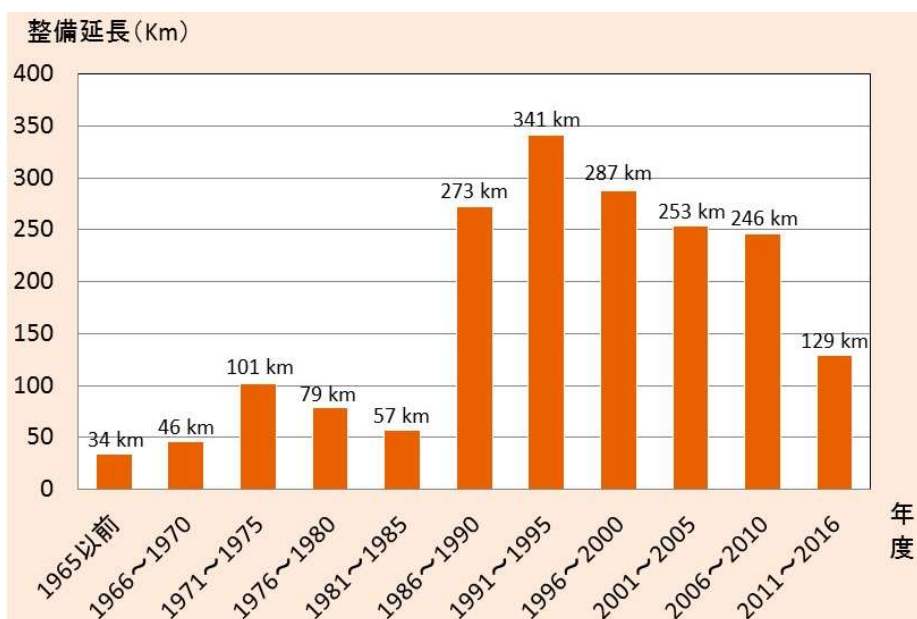
図 3-10 下水道管路の年度別整備延長
