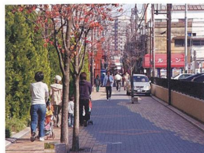
写真 2-17 街路樹と舗装パターンにより速度抑制の工夫をした事例（埼玉県さいたま市）
