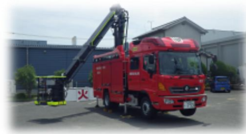
【13mブーム付多目的消防ポンプ自動車】
