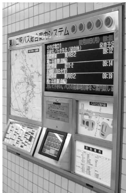
図 バス総合案内システム設置例
