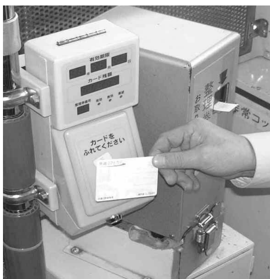
図 バス I Cカード導入例
