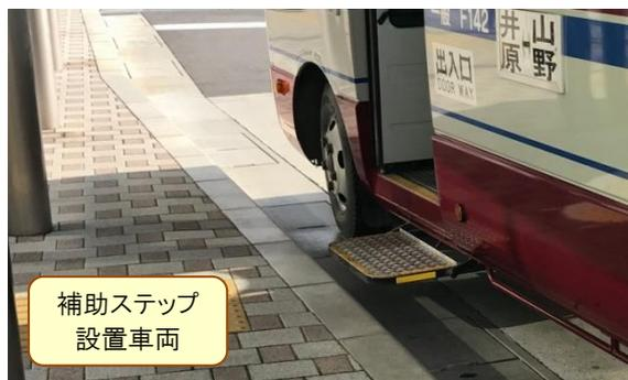
図 低床車両・補助ステップ
