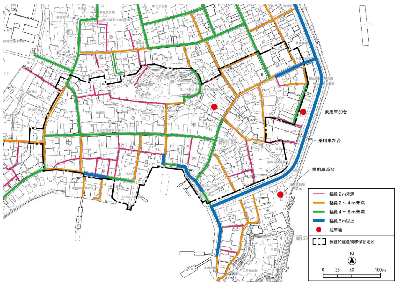
図1-26 幅員別道路の現況
