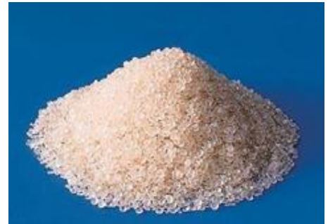
〔使用済みトレーを再加工しやすく粒状にしたペレット〕
