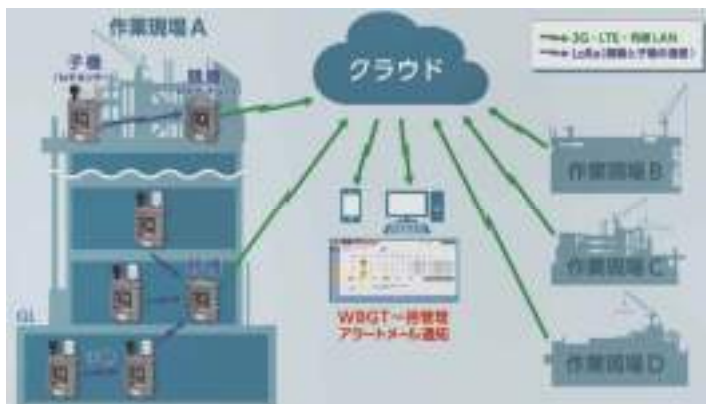
タブレット端末等でWBGT値を確認可能なシステムの活用
